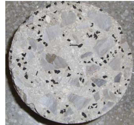
Probeta de hormigón con granulado de neumáticos fuera de uso
