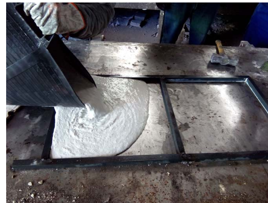
Vertido del hormigón en los moldes. Primeros prototipos
