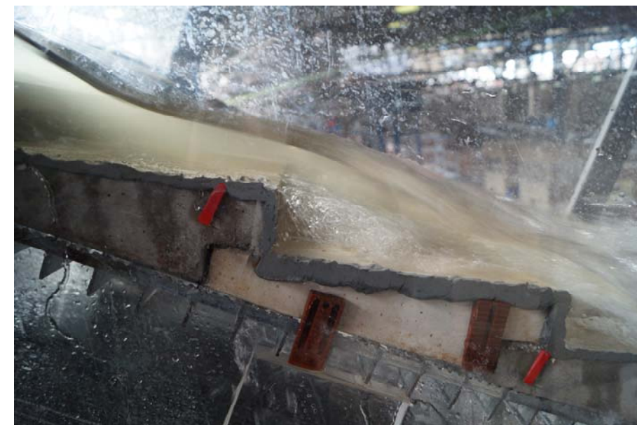
Instalaciones de ensayo en modelo físico de aliviadero con bloques en forma de cuña en funcionamiento.
